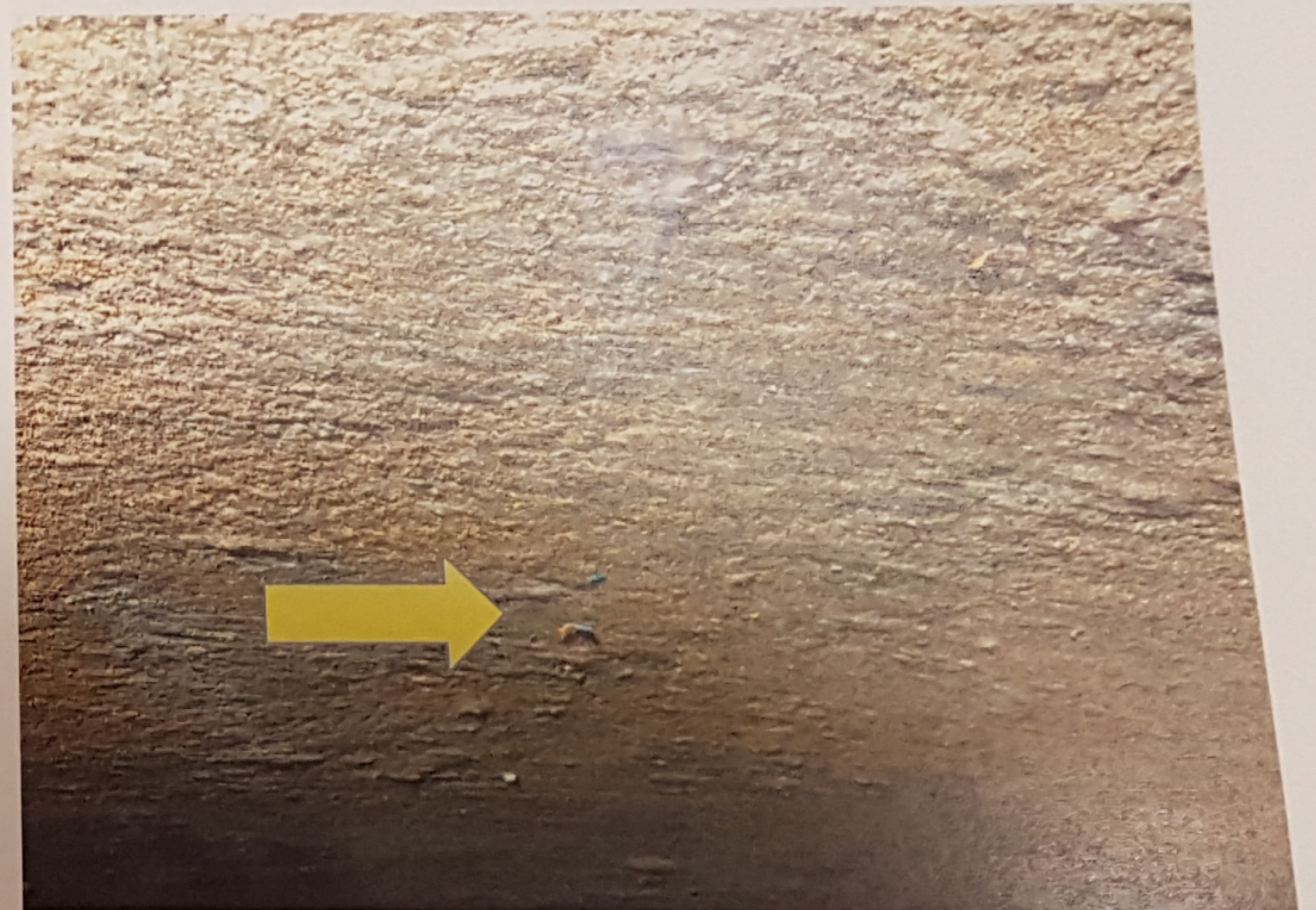
Bild Nr. 8 - Farbpartikel auf der Innenwand der Wasserkammer
