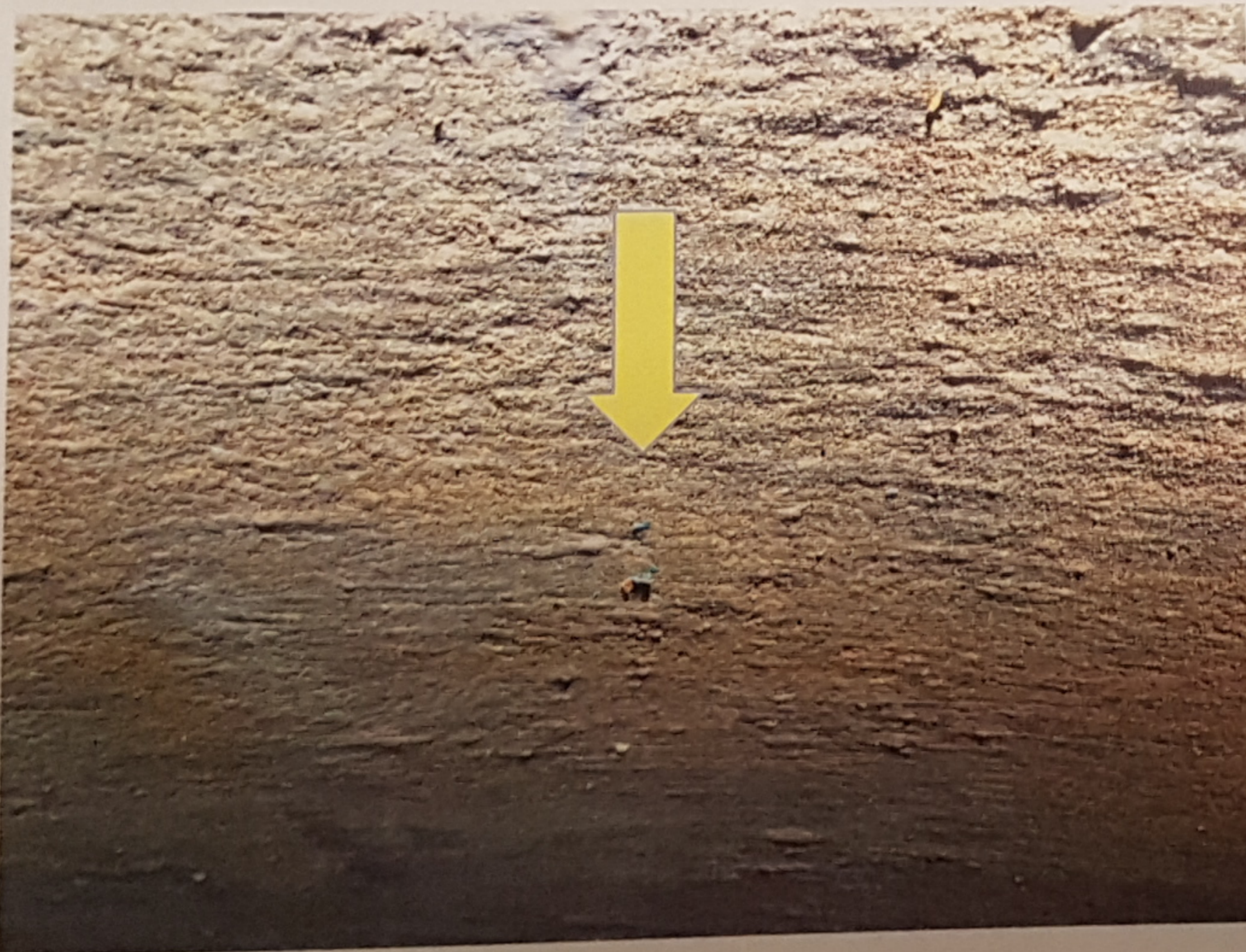
Bild Nr. 9 - Farbpartikel auf der Innenwand der Wasserkammer
